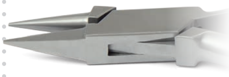
ZLH514 Pinza a becco d'uccello, punte lunghe, per laboratorio - Laboratory bird beak long plier Specifica per eseguire loop - Designed for loop forming. ● Max 0.018" (0,46 mm)
